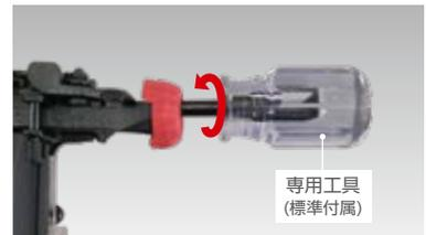
(注) ビット交換時は必ずエアホースを外してください。新しいビットのねじ部に付属の油を塗布してから交換してください。
